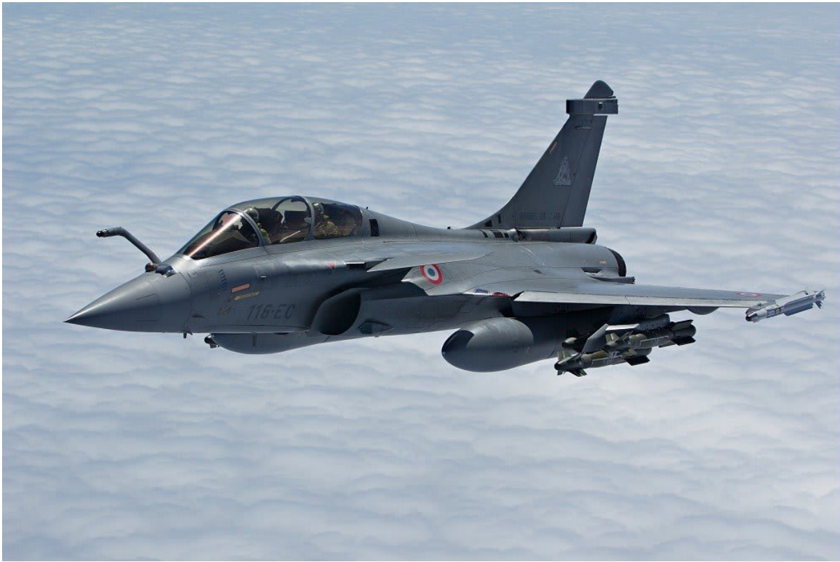
Fransız Dassault Rafale Savaş Uçağı, MICA hava-hava ve ASSM hava-kara füzeleri ile 33
